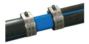
100 mm Rohr freistellen. Rohrenden leicht seitwärts biegen und den Reparatur-Verbinder bis zum O-Ring in eines der beiden Rohrenden schieben. Die Schellen bündig auf die Rohrenden schieben.
